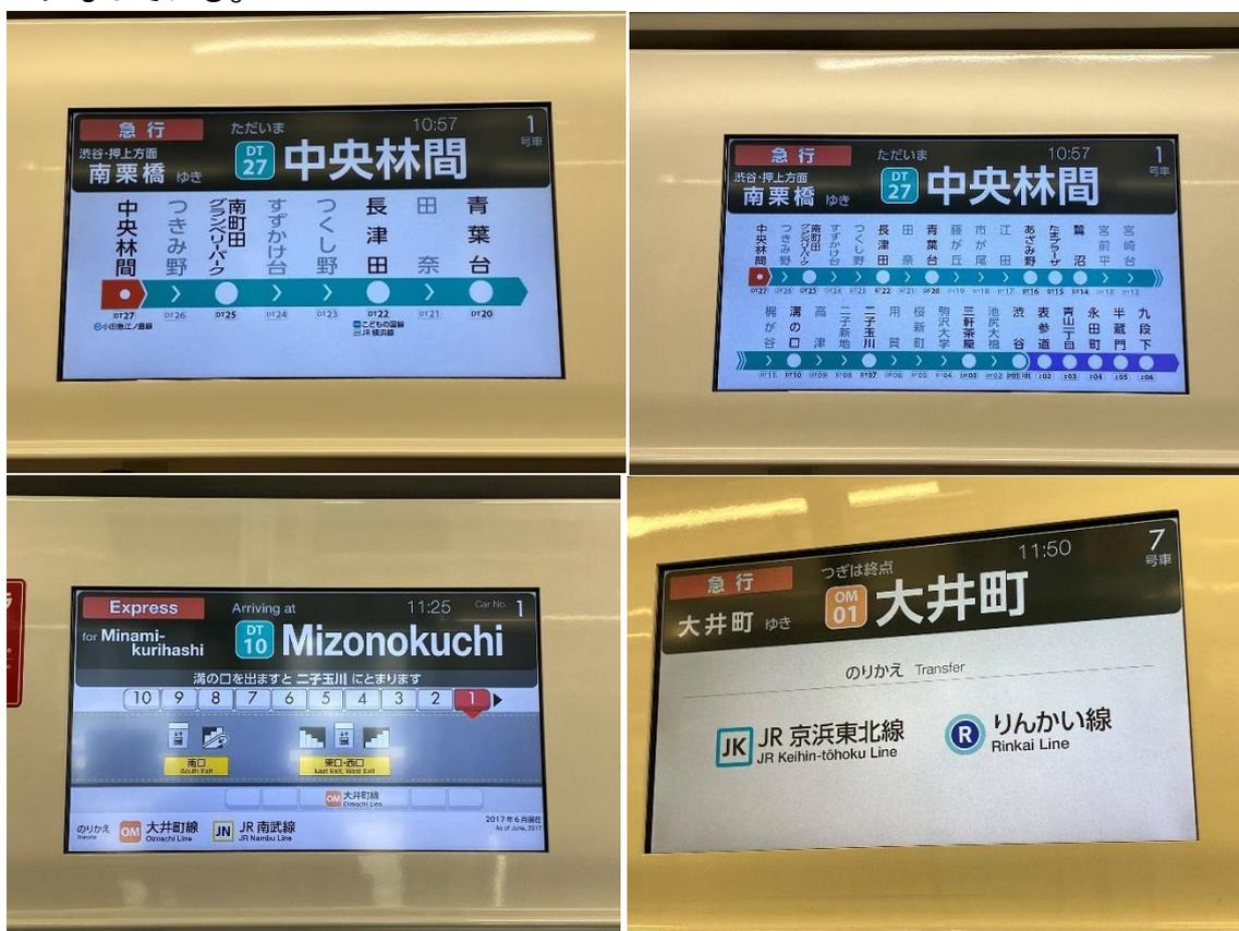
「LCD(Liquid Crystal Display)」とは、ドアの上部に設置されている液晶ディスプレイのことである。2020系列にはどの車両にもLCDは設置されている。違いがあるのは1両あたりの設置台数である。3020系・6020系ではドア上部に在線位置の表示と広告用に2台設置されており、1両あたりドアは8枚あるため合計で16台ある。しかし、2020系はドア上部の16台に加えて、ドアとドアの間の座席上部にも広告用のものが3台、連結部の上部にも1台あり、合計で36台(先頭車は35台)設置されている。3020系・6020系では、座席の上部には紙の広告が入れている。なぜ2020
