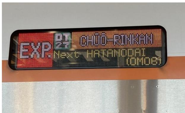
側面に設置されているLED 表示機は、従来のものに加えて、駅ナンバリングと次の停車駅の表示が追加されている。
