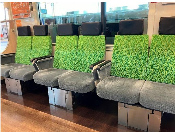
このQ-SEAT は、ロングシートとクロスシートが切り替えられるものが取り付けられている。普段は向かい合わせのロングシートだが、Q-SEAT 運用時は、進行方向を向いたクロスシートに回転させて変えることができる。ロングシートのときはほかの車両と同じように乗ることができるが、クロスシートの場合、事前に席を指定したうえで追加料金を払わないと乗ることができない。このQ-SEAT は全て平日夜の大井町発長津田行きの車両で運用される。その際には大井町から二子玉川までの停車駅は乗
